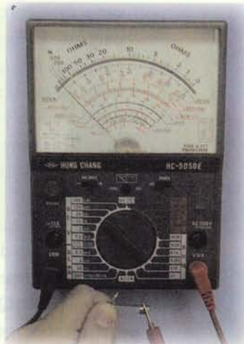
Figura 2.28b. Midiendo continuidad en un fusible. La aguja marca infinito o sea que está malo
